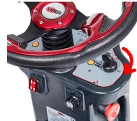
Gire la llave para conectar la máquina. Gire el regulador de velocidad completamente hacia la izquierda.
