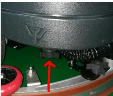
Quite el tapón del depósito para vaciarlo. Si cambia de producto químico, enjuague el depósito antes de volver a llenarlo de agua.
