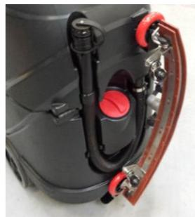
Para guardar la boquilla, puede ponerla en la parte posterior de la máquina.
