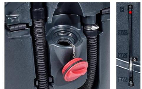
Por la parte posterior de la máquina, llene el depósito con 72 litros de agua como máximo y añada la cantidad de detergente adecuada.
