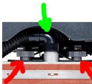
Coloque y atornille la boquilla, conecte la manguera.
