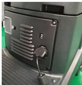
Conecte el cable del cargador a la corriente. **La luz se vuelve verde cuando está totalmente cargada.**
