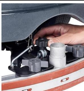
Gire el regulador del brazo de la boquilla para ajustar la recogida de agua.
