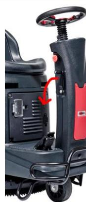
Al bajar la palanca de la boquilla, la aspiración se conecta automáticamente y se apaga cuando se levanta.
