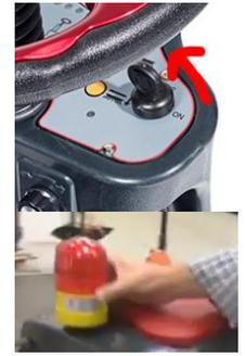
Apague la máquina con la llave y apague la luz intermitente.
